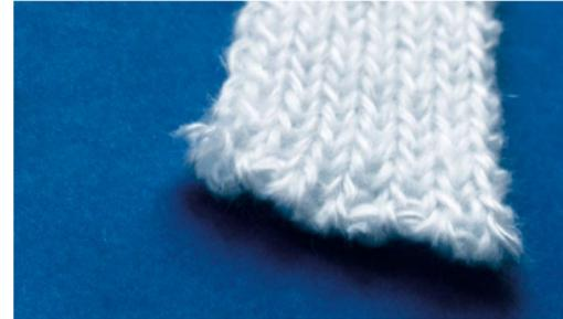
Die dewaheat®-Produkte werden aus hochtemperaturbeständigen Fasern und Garnen hergestellt. Diese Erzeugnisse erlauben Dauertemperaturbelastungen bis 1100°C. Zu ihnen zählen Stopwatte, Sliver, gestrickte Bänder und Schläuche sowie Flachgestricke.
